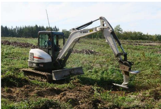
Photo 1 : Sous-soleur multifonctions de type Becker (mini-pelle 5 T)
